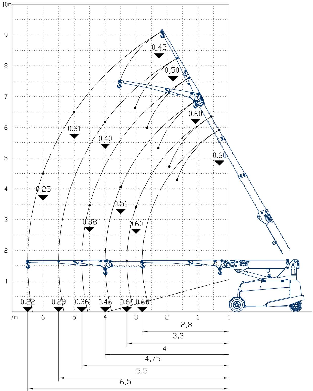
Fleche de base + Jib mécanique 1,5t + allonge de jib + treuil , inclinable 3 positions 0-25-50
