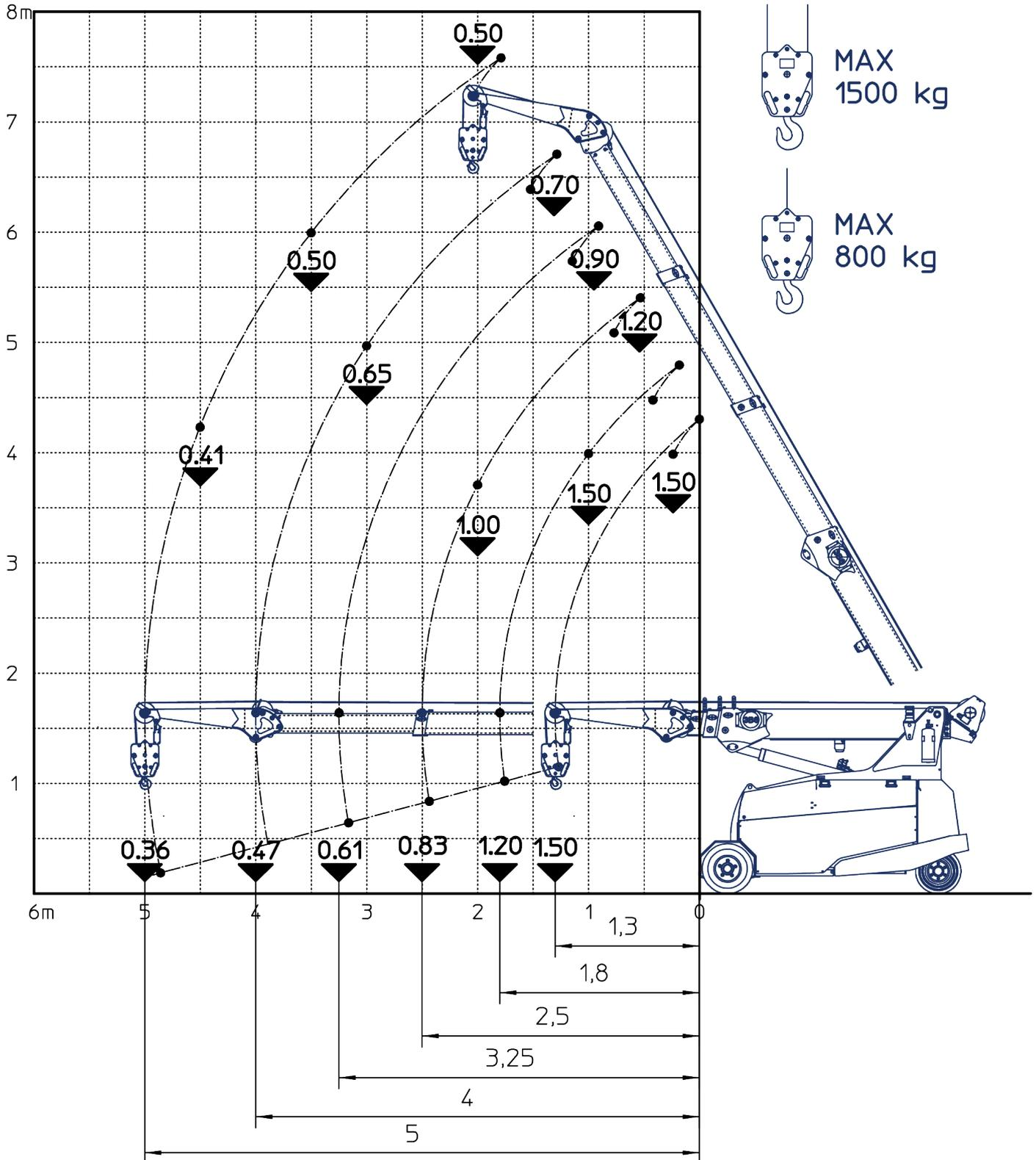
**Fleche de base + Jib mécanique 1,5t + allonge de jib , inclinable 3 positions 0-25-50°**
