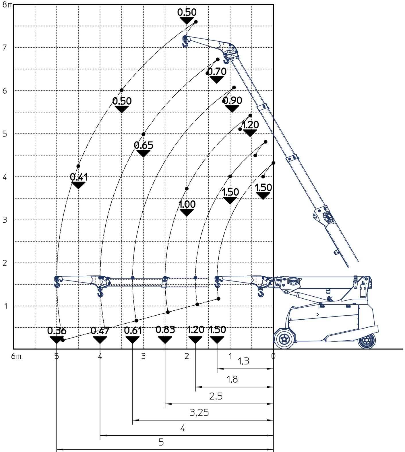
Fleche de base + Jib mécanique 1,5t avec Treuil, inclinable 3 positions 0-25-50°
